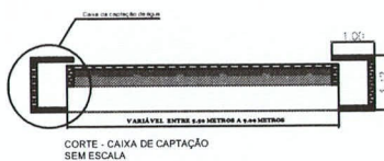
CORTE - CAIXA DE CAPTAÇÃO SEM ESCALA
